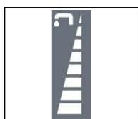
Символ регулировки количества воды. Находится на рулевой колонке и указывает на ручки регулирования количества воды, распределяемой гидроустановкой машины.
