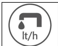
Символ регулирования объема горячей воды (только для системы CDS).
